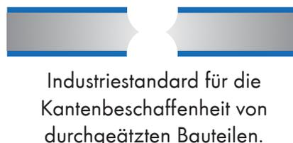
Industriestandard für die Kantenbeschaffenheit von durchgeätzten Bauteilen.
